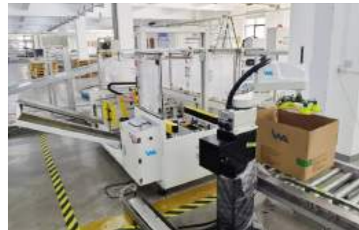
自动开箱系统 Automatic unpacking system
